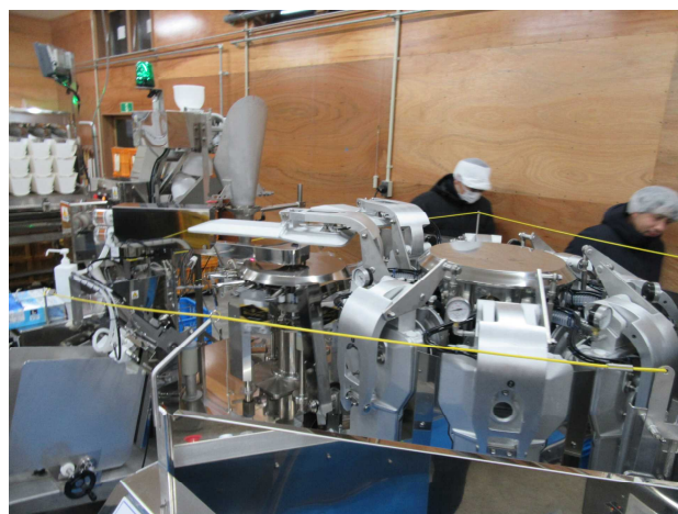
＜図＞いぶりがっこ堅型袋詰真空包装機の導入
